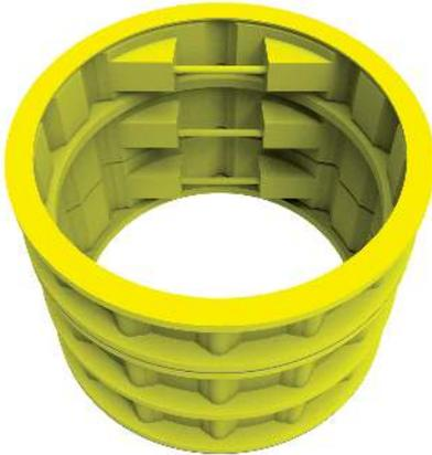
منهول های پیش ساخته پلی اتیلنی تولید شده در شرکت به آب شکوه خضراء به صورت پله سر خود می باشند. پس از قرار گرفتن قطعات منهول پلی اتیلنی به روی یکدیگر، پله ها مانند یک نردبان یکپارچه در امتداد یکدیگر قرار می گیرند. این نردبان دسترسی به شبکه آب، فاضلاب و ... را تسهیل می کند.
